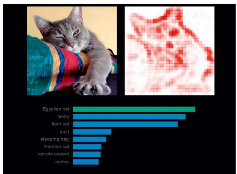
Im LRP-Verfahren (Layer-Wise Relevance Propagation) wird ermittelt, welcher Input welchen Anteil am Ergebnis hatte; eine Heatmap (rechts) markiert die Bereiche mit dem größten Gewicht. Dabei offenbart sich hier: Es sind fälschlicherweise auch Teile des Bettbezugs in die Entscheidung eingeflossen.
